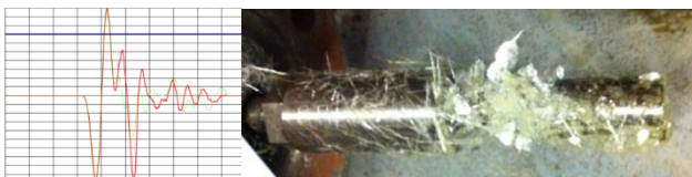
Verfälschtes Ultraschallsignal und verschmutzter Messkopf
